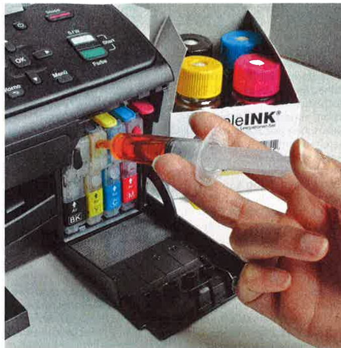
Der Alternativanbieter Compedo liefert nachfüllbare Ersatzpatronen für Brother-Drucker. Sie lassen sich direkt im Drucker nachbetanken.
